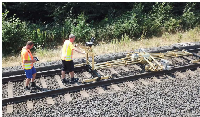
Mesure de la géométrie de la voie avec EMA uni
