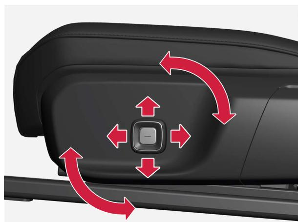
La manopola di regolazione del sedile può muoversi in alto e in basso, a sinistra e destra, come anche ruotare in entrambe le direzioni. Nel centro della manopola si trova anche un pulsante che si può utilizzare per attivare la modalità di regolazione.
