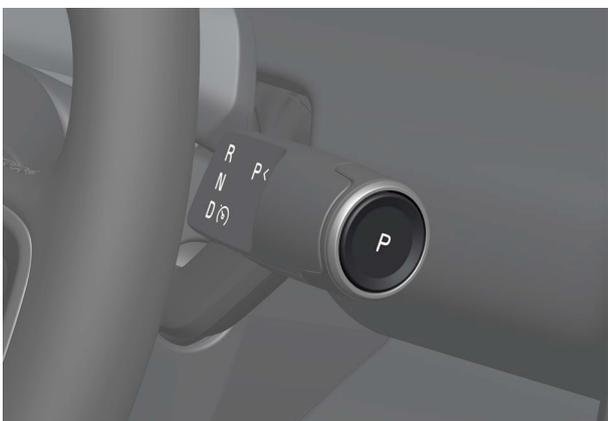
Il freno di stazionamento si disinserisce automaticamente quando viene selezionata una marcia.
