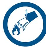
Se la batteria ad alta tensione prende fuoco o fuoriesce gas od odore, usare sempre acqua per raffreddarla. Utilizzare acqua depurata per raffreddare l'area intorno alla batteria.
