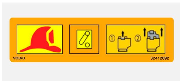
2. Localizzare il connettore di scollegamento del servizio alta tensione sul lato sinistro del vano motore. Il connettore può essere identificato mediante un'etichetta sul fascio cavi.
