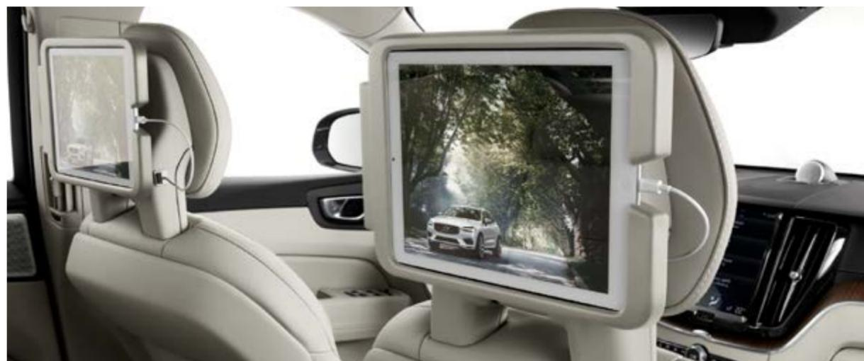
A00462 - Supporto per iPad con sistema di ricarica del dispositivo
